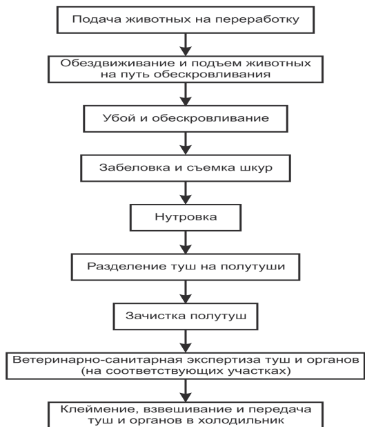
Рис. 1.3. Технологическая схема переработки крупного рогатого скота
