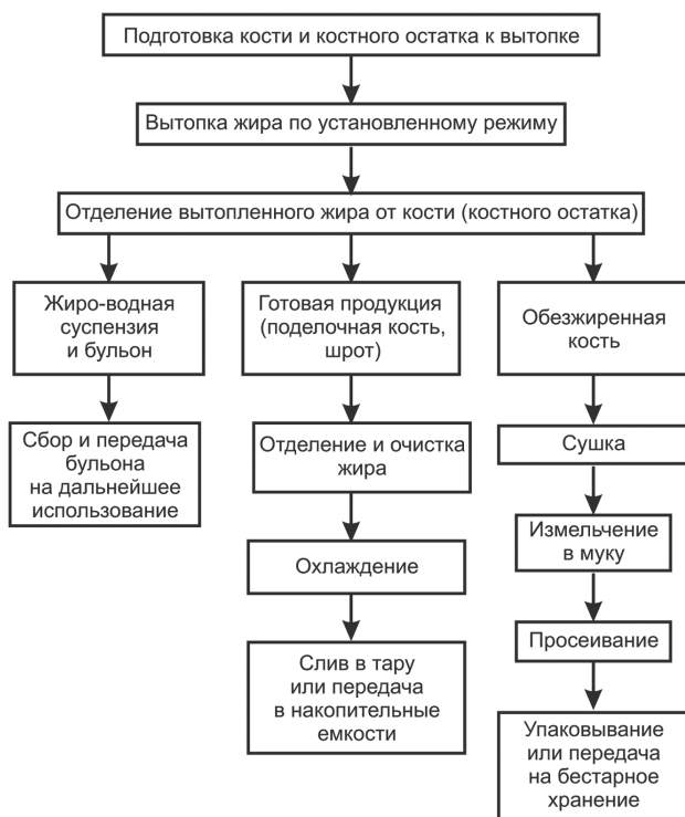
Рис. 2.7. Технологическая схема производства пищевого жира из кости и костного остатка
