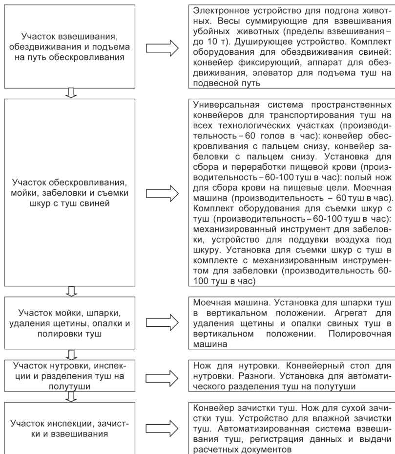
Рис. 2.3. Схема использования оборудования на различных участках процесса переработки свиней
