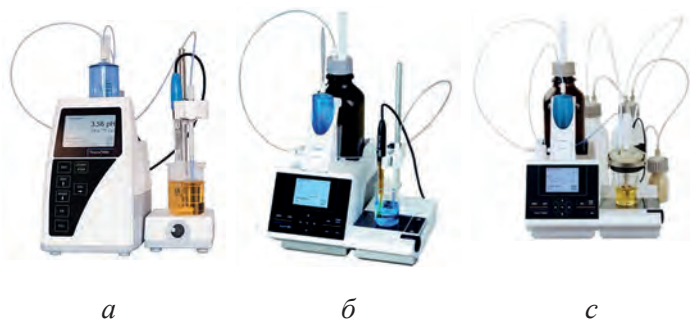
Рис. 23. Титраторы TitroLine 5000 (а), TitroLine 7000 (б), TitroLine 7750 (с) (компания «SI Analytics»)
