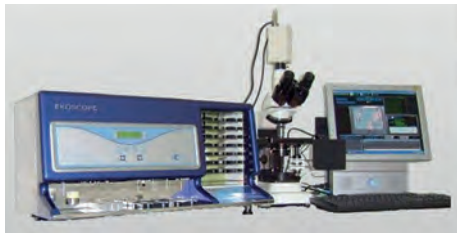
Рис. 38. Автоматизированная система микроскопического способа подсчета соматических клеток в молоке и молочной продукции EkoScope
