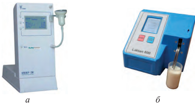
Рис. 2. Анализаторы молока Клевер-2М (а) и Лактан 1-4М исп. 600 УЛЬТРАМАКС (б)
