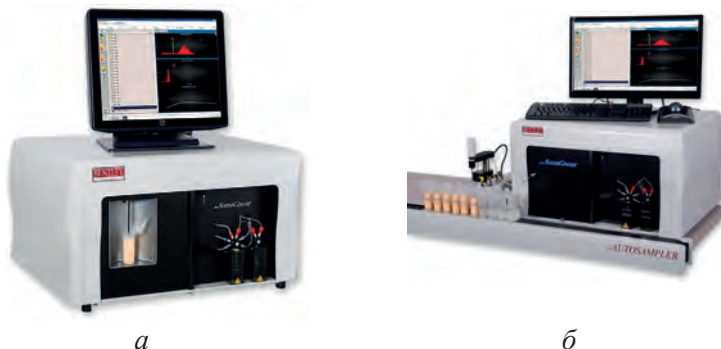
Рис. 36. Анализаторы соматических клеток Somacount FC (а), Somacount FC с автоматическим пробоотборником (б)
