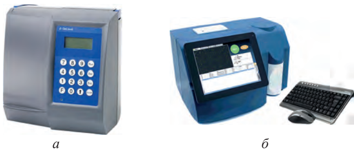
Рис. 36. Анализатор соматических клеток в молоке DCC (а) и анализатор соматических клеток Ультрасоматик А10 (б)
