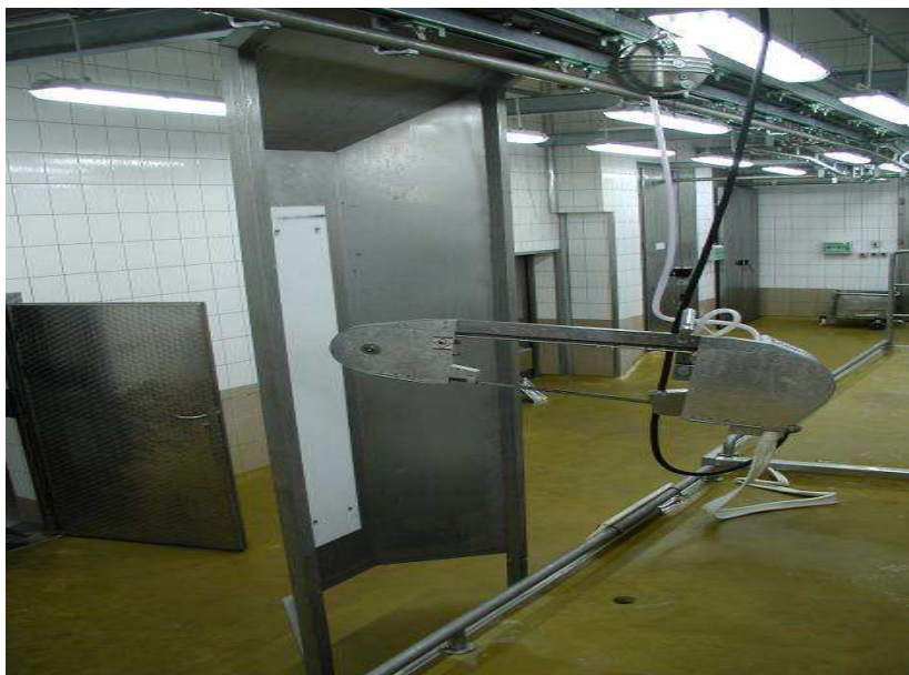
Рис.2.112. Защитный экран для пилы
