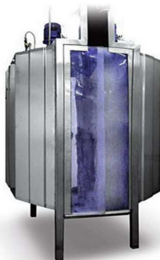
Рис. 2.133 Машина для мойки свиных туш
