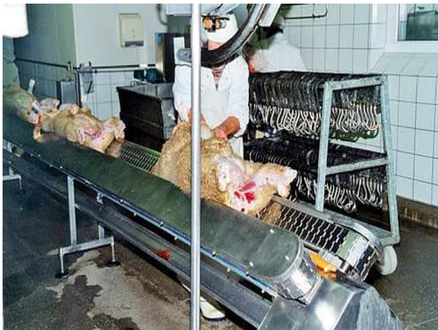
Рис.2.157. Конвейер забеловки овец
