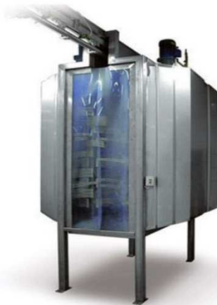
Рис. 2.132. Устройство для мойки свиных туш
