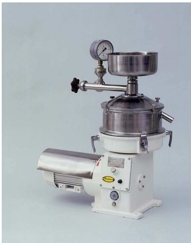
Рис. 2.47 Сепаратор для разделения крови
