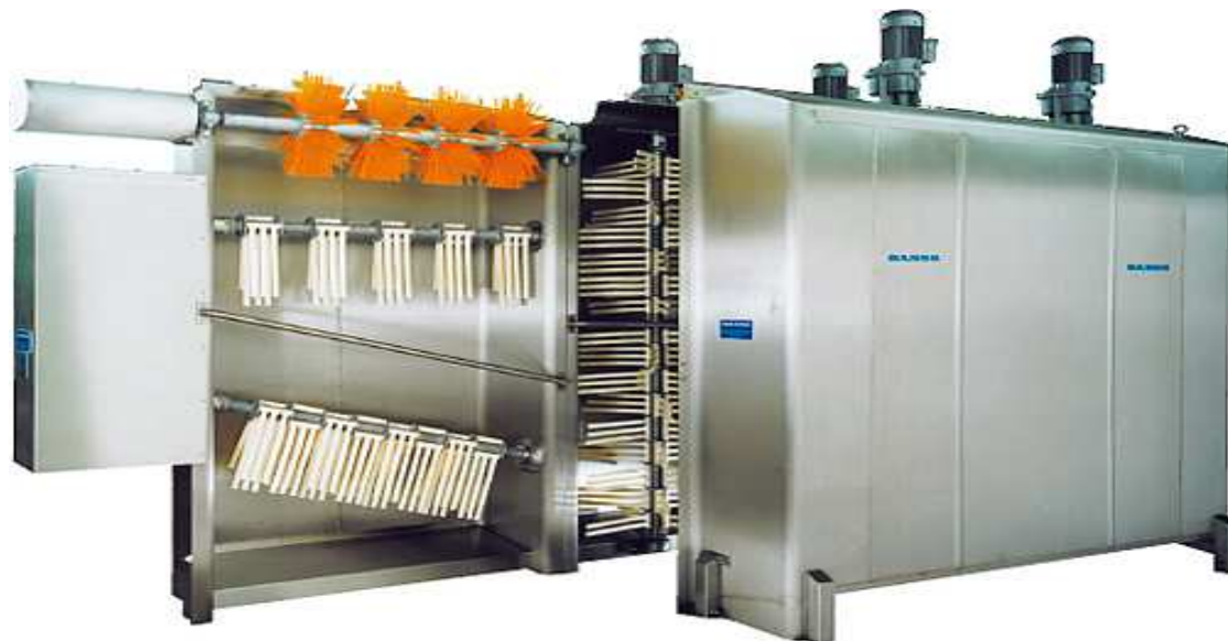
Рис. 2.141 Машины предварительной зачистки, мойки и сушки туш
