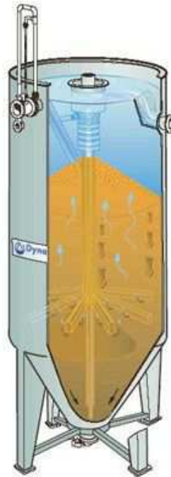
Рис. 2.81 Самопромывной песчаный фильтр (конструкция).
