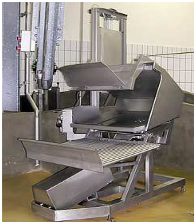
Рис. 2.155 Бокс ритуального оглушения для овец и коз
