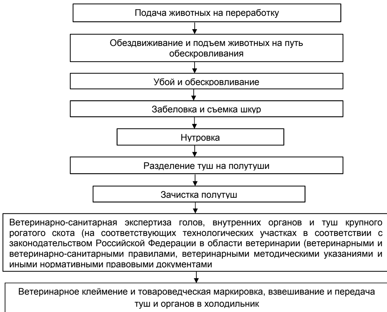
Рис. 2.3. Технологическая схема переработки крупного рогатого скота.
