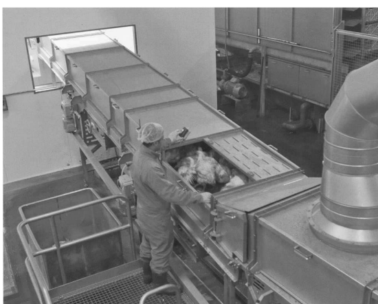
Рис. 2.26 Подача птицы по ленточному конвейеру
