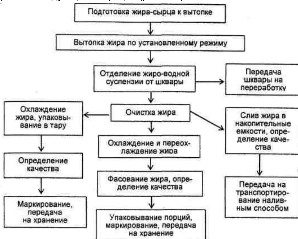
Рис. 2.65 Технологическая схема производства пищевого жира из жира-сырца
