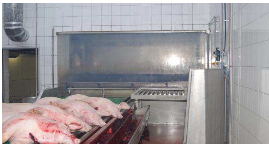
Рис. 2.126. Конвейерный стол для обескровливания животных
