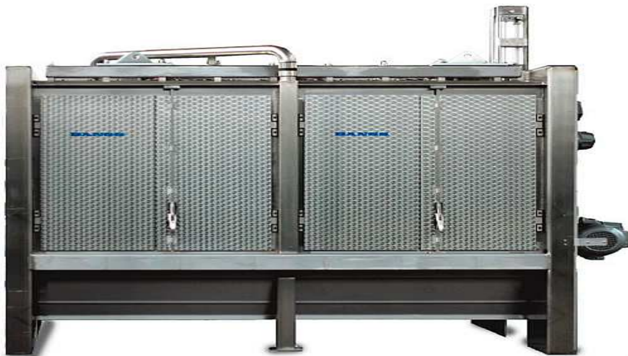
Рис. 2.140. Машина для обезволашивания
