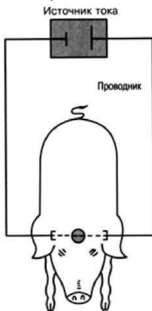
Рис. 2.13 Схема обездвигивания свиней электрическим током
