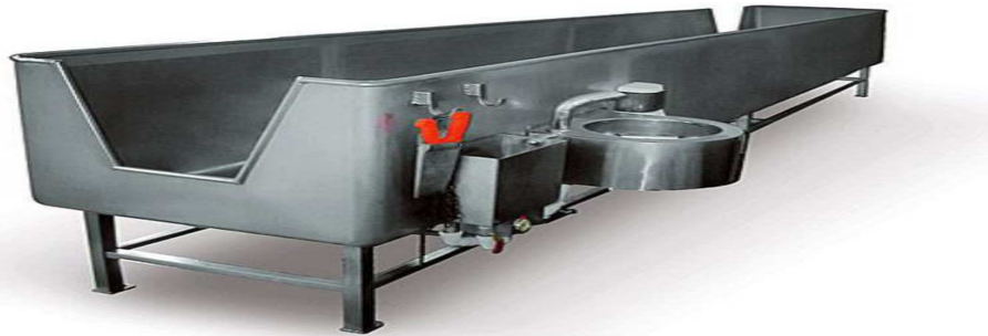
Рис. 2.127. Ванна для обескровливания
