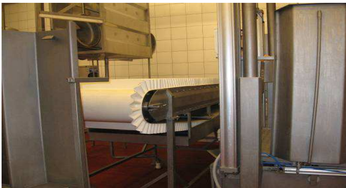
Рис. 2.115. Ленточный конвейер для обработки кишечного сырья
