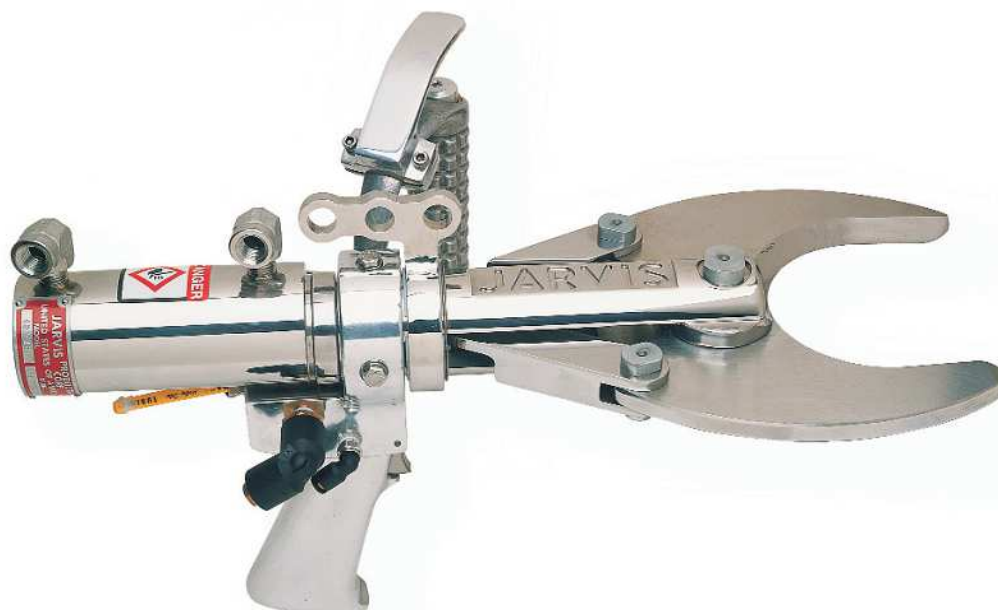
Рис. 2.158. Ножницы для удаления конечностей
