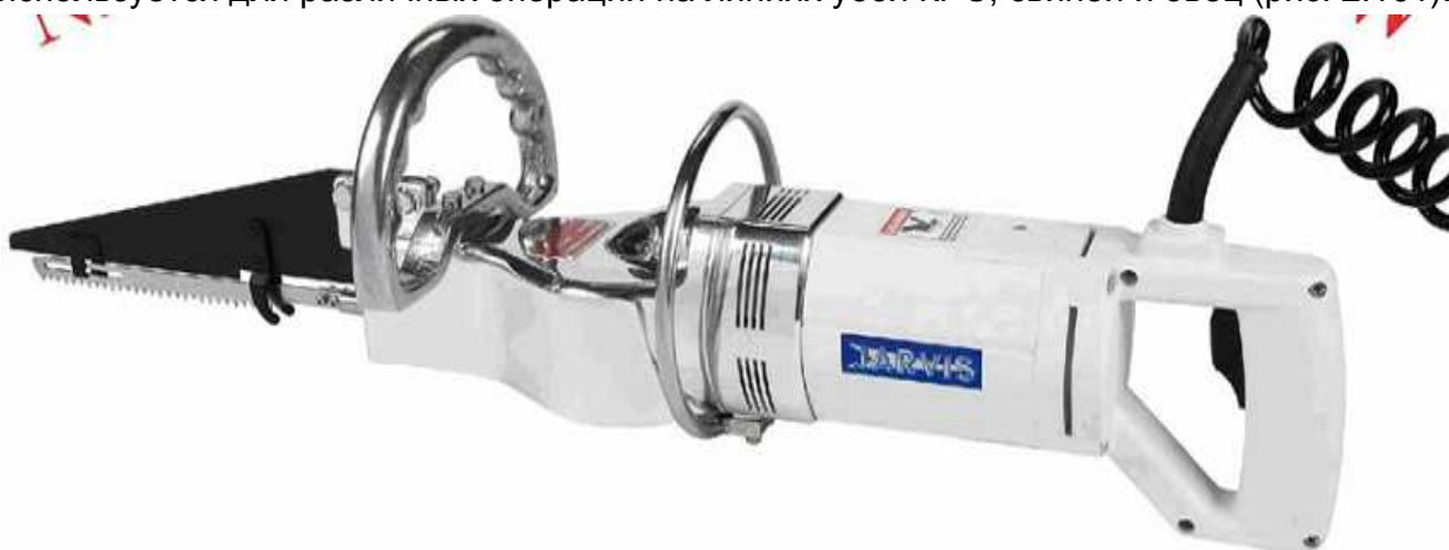
Рис. 2.101 Пила для разделки туш
