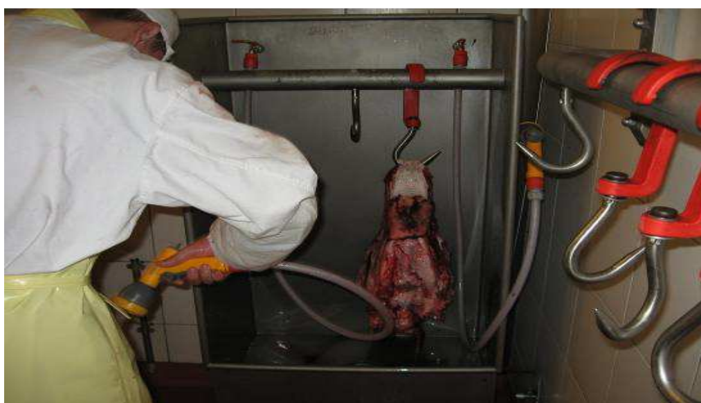
Рис. 2.111 Устройство для мойки голов
