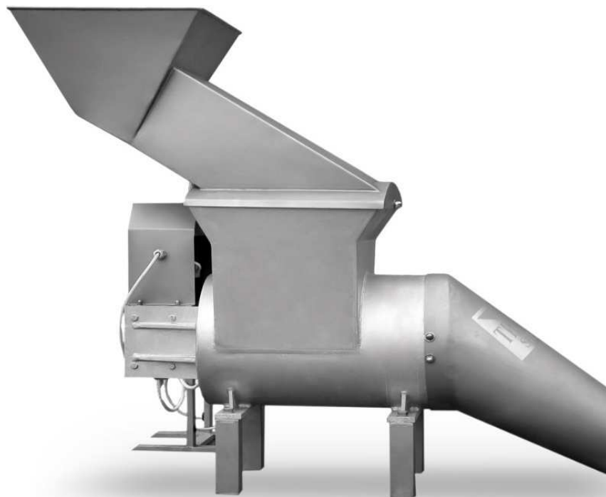
Рис. 2.118. Шнековая дробилка отходов
