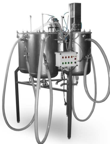
Рис. 2.129 Устройство для сбора крови на пищевые цели
