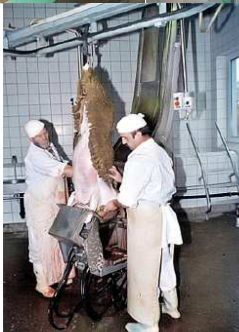
Рис.2.156 Шкуроръемка для овец. Вертикальное обескровливание
