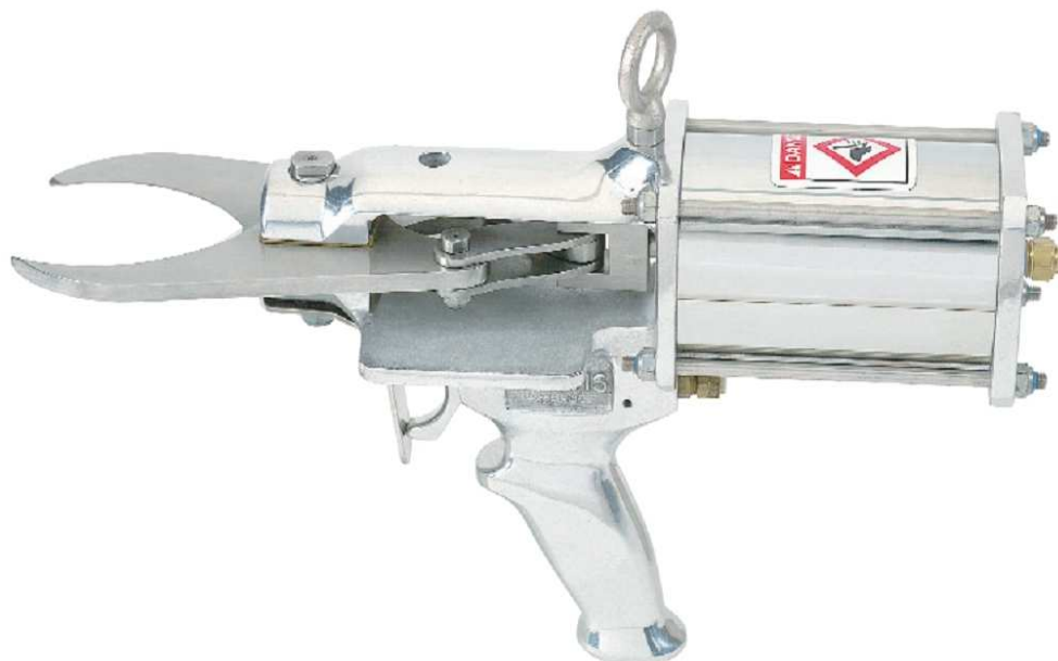
Рис. 2.163 Резак для лапок и шей кур, гусей и страусов
