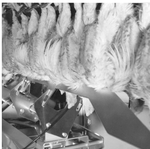
Рис. 2.33 Аппарат для обескровливания К15
