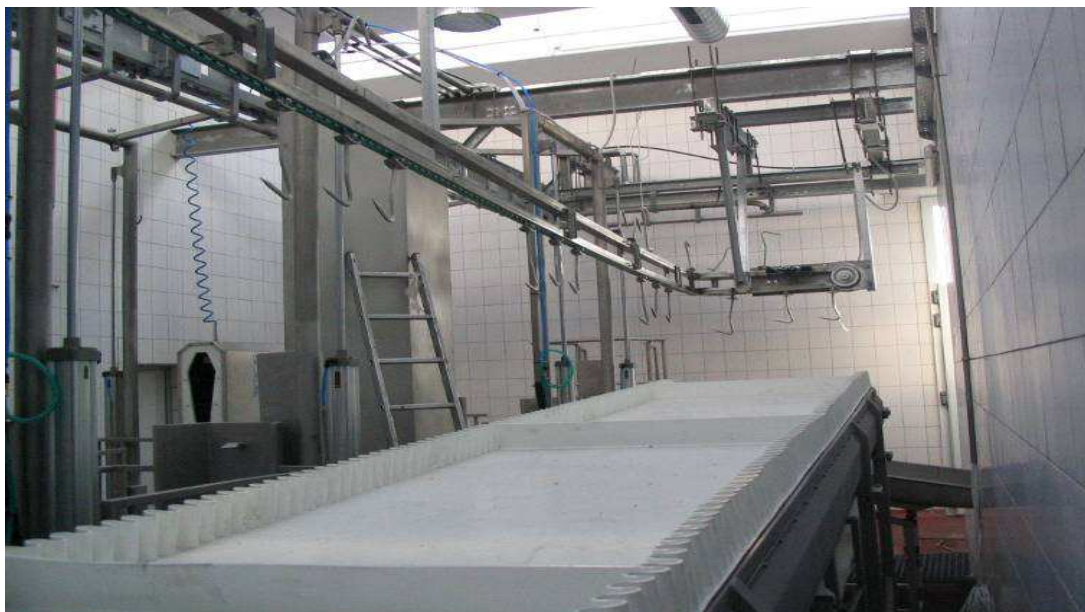
Рис. 2.114 Конвейер для транспорта голов и субпродуктов
