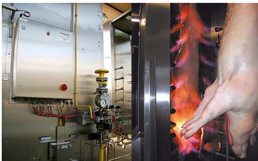
Рис. 2.142. Печи для опалки свиных туш
