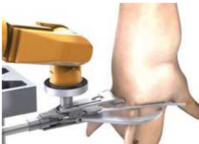
Рис. 2.151. Отделение головы свиней гидравлическими ножницами
