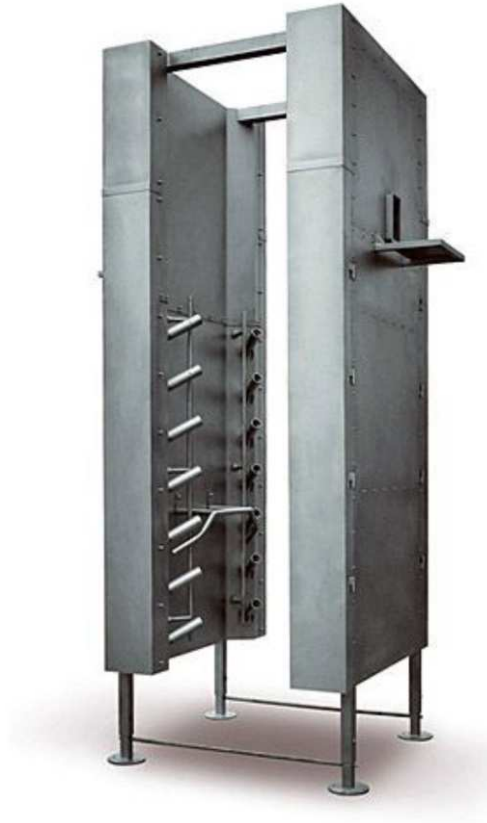
Рис. 2.144. Печь для опалки свиных туш
