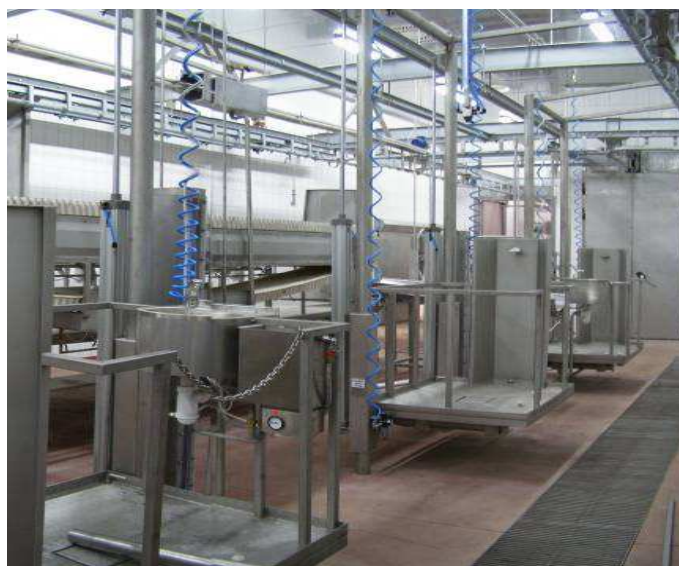
Рис. 2.107 Пневматическая подъемно-опускная площадка
