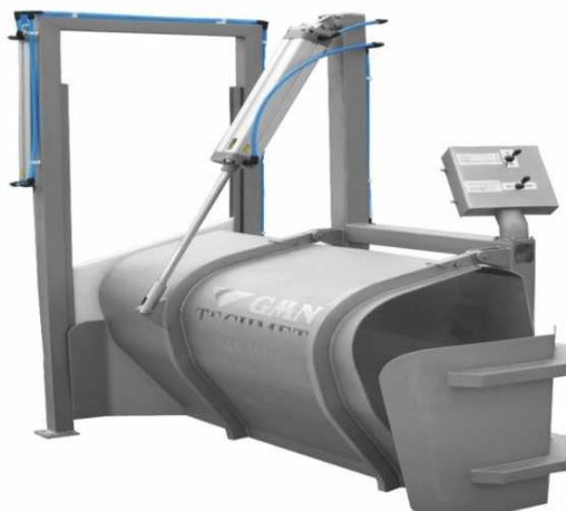
Рис. 2.122. Пневматический бокс для оглушения свиней
