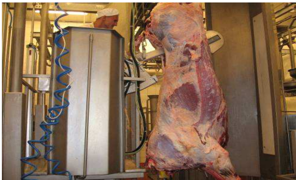
Рис. 2.113. Подъемно-опускная площадка для распиловки туш
