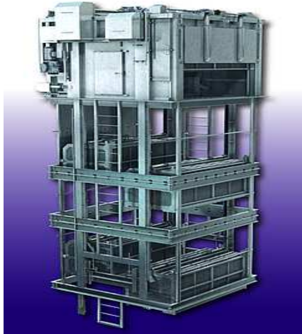
Рис. 2.121 Автоматическая установка для оглушения посредством \text{CO}_2
