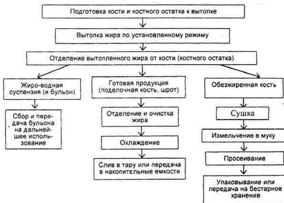
Рис. 2.63 Технологическая схема производства пищевого жира из кости и костного остатка
