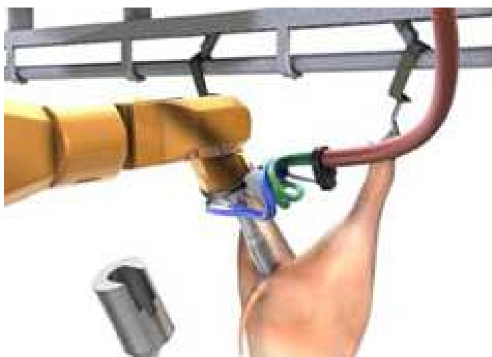
Рис. 2.149. Роботизированный участок удаления прямой кишки
