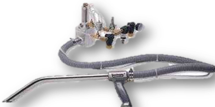
Рис. 2.162 Пистолет для удаления лёгких и почек у птицы
