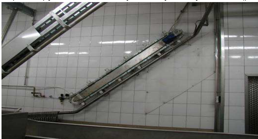
Рис. 2.130. Устройство для транспортирования пуп
