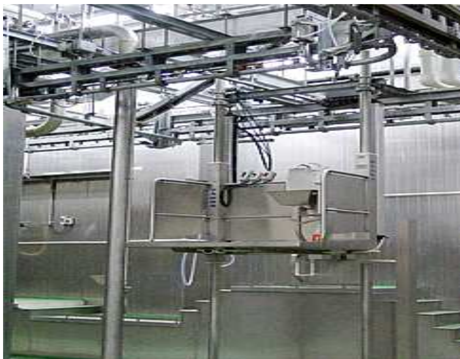
Рис. 2.99 Автоматическая установка для распиловки туш КРС
