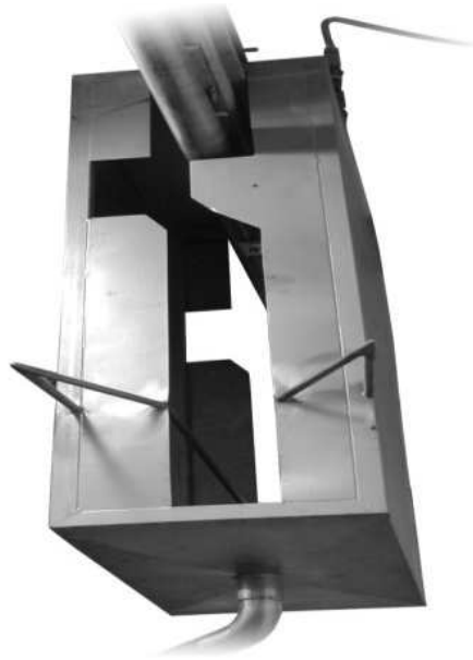
Рис.2.140. Устройство для мойки пут
