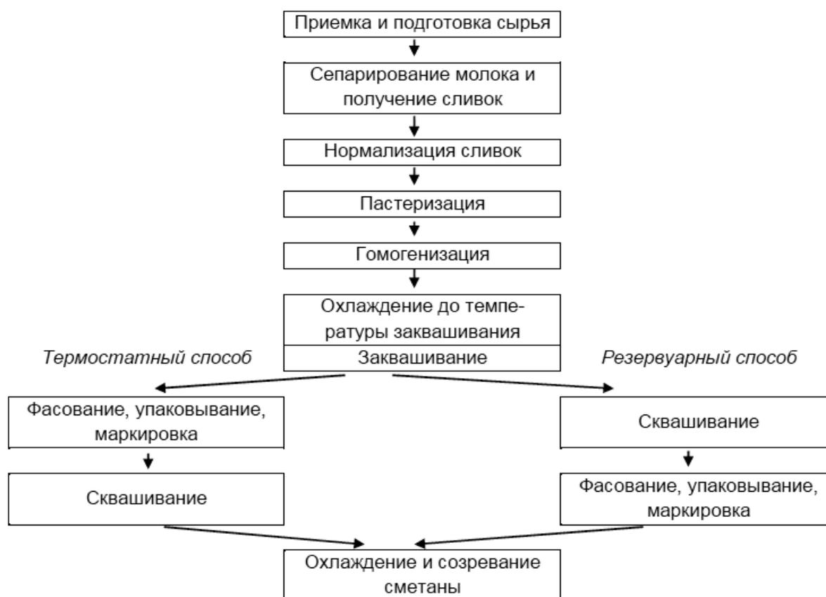
Рисунок 2.8 - Технологическая схема производства сметаны
