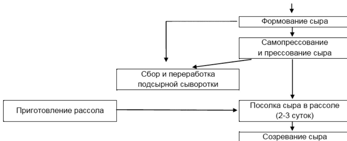
Рисунок 2.14 - Общая схема процесса производства полутвердых сыров
