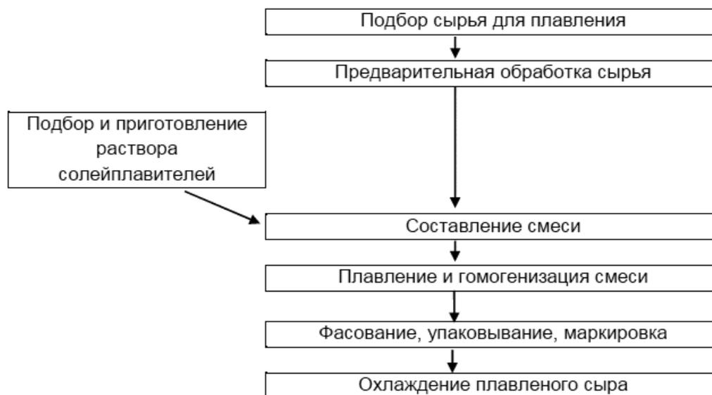
Рисунок 2.16 - Общая схема производства плавленых сыров
