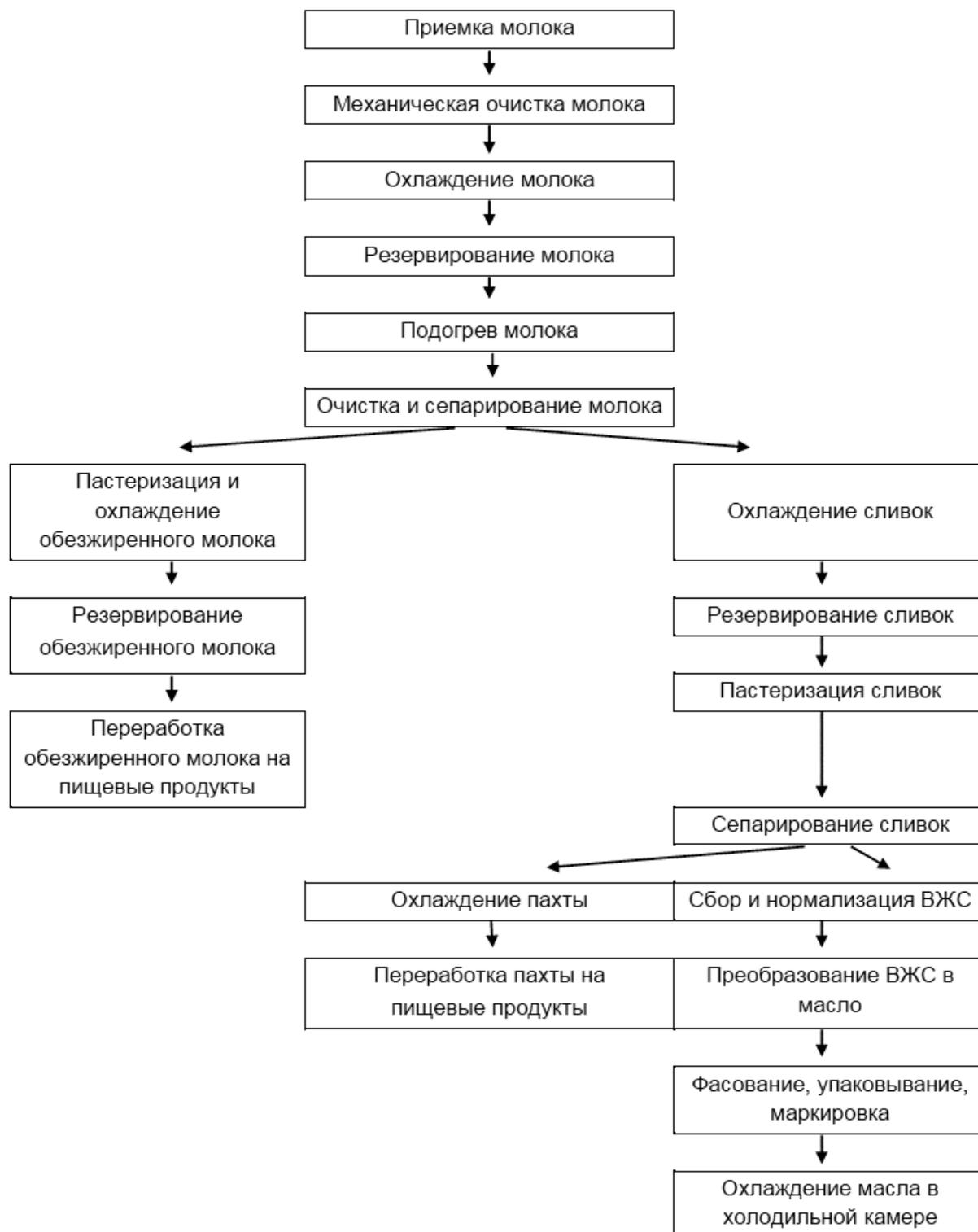
Рисунок 2.10 - Общая схема процесса производства сливочного масла методом ПВС
