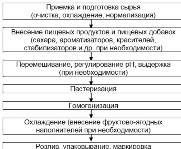
Рисунок 2.6 - Технологическая схема производства молочных напитков
