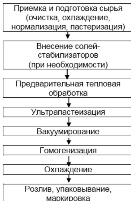
Рисунок 2.4 - Технологическая схема производства ультрапастеризованного молока (с использованием пароконтактного способа путем инъекции пара в молоко)
