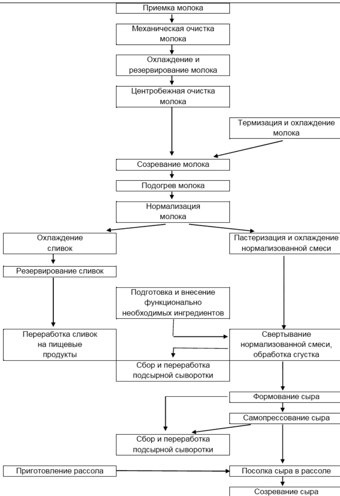
Рисунок 2.15 - Общая схема процесса производства мягких сыров
