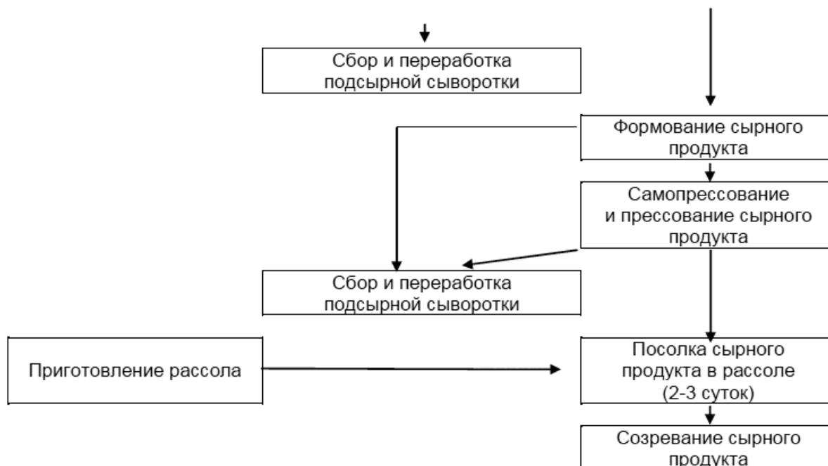
Рисунок 2.17 - Общая схема производства полутвердых сырных продуктов
