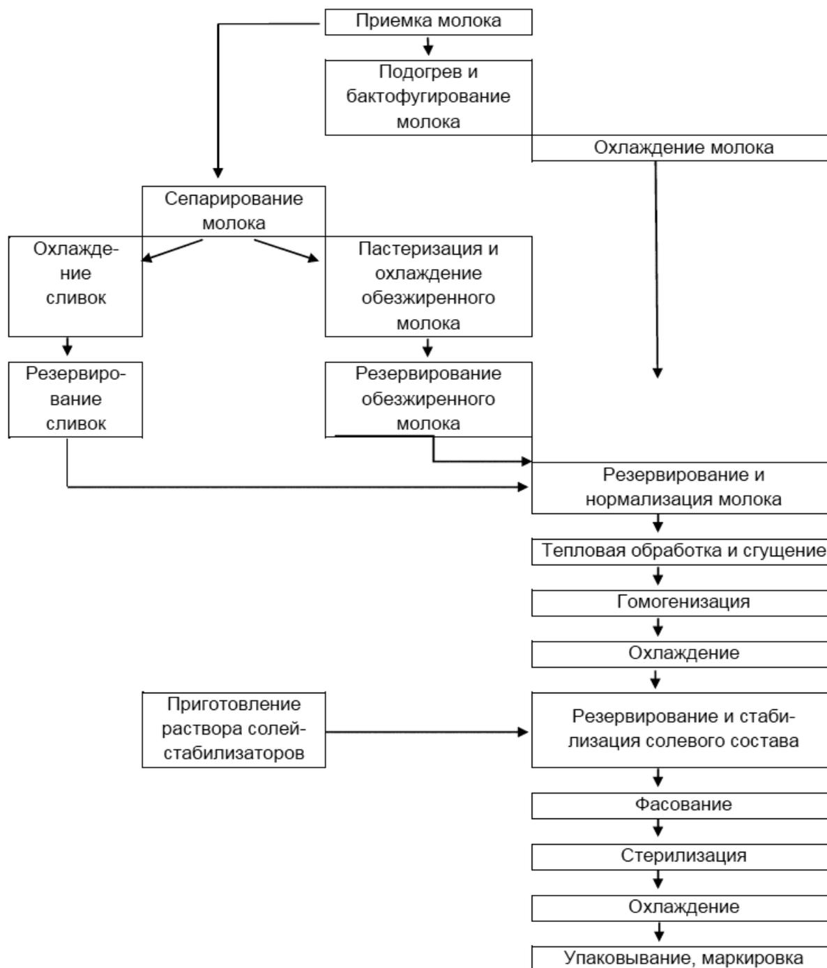
Рисунок 2.21 - Схема технологического процесса производства сгущенного стерилизованного молока
