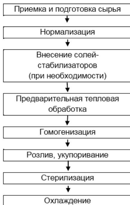
Рисунок 2.2 - Технологическая схема производства стерилизованного молока (сливок)
