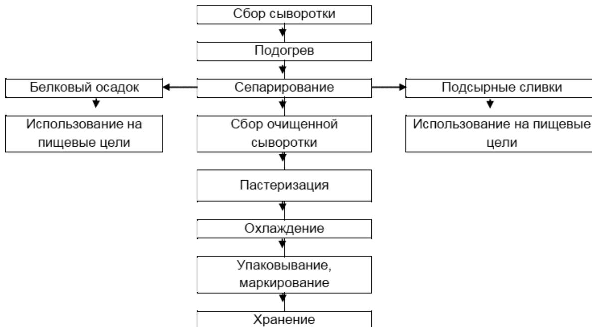
Рисунок 2.25 - Технологическая схема производства питьевой пастеризованной сыворотки
