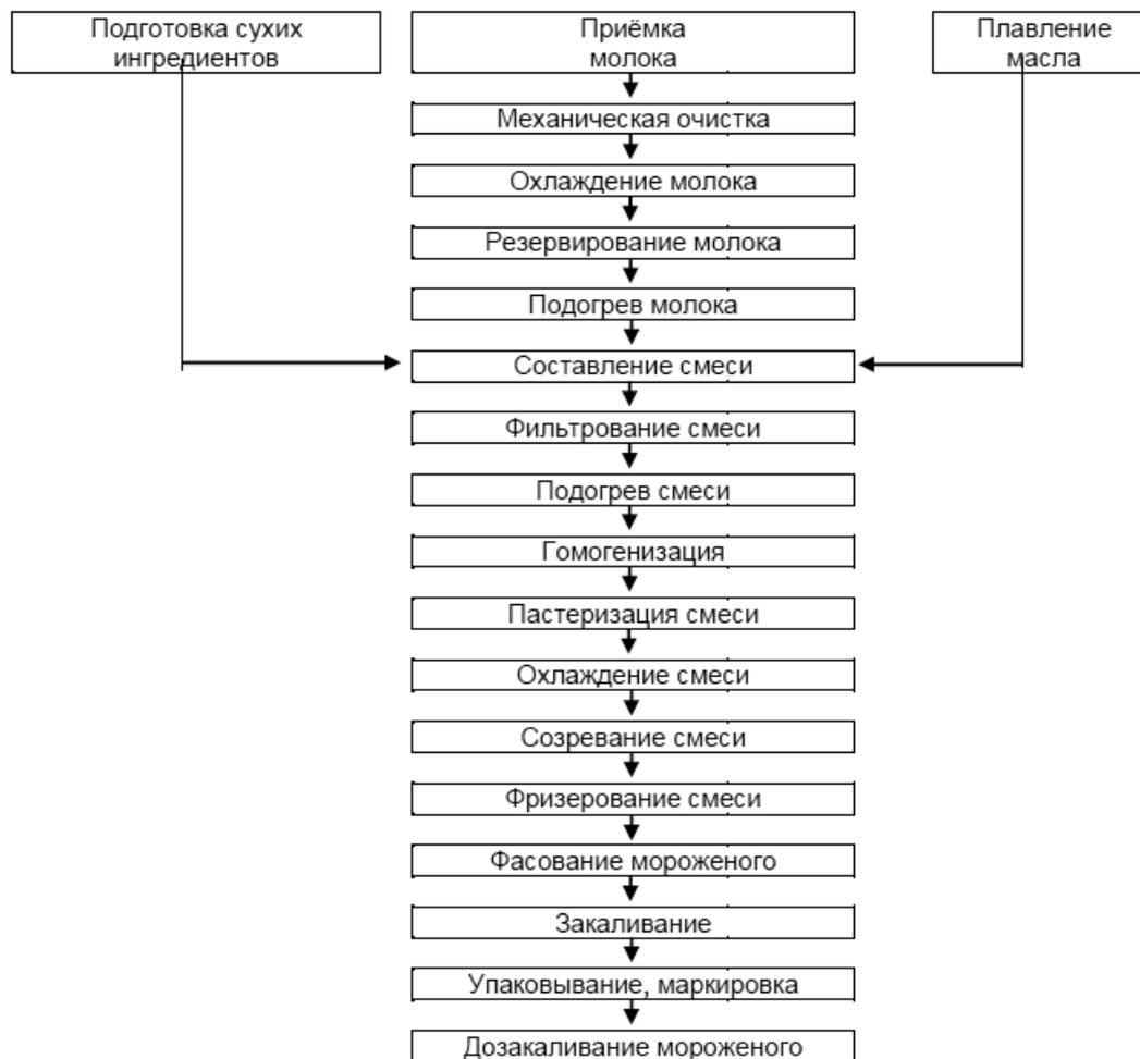
Рисунок 2.22 - Схема технологического процесса производства мороженого
