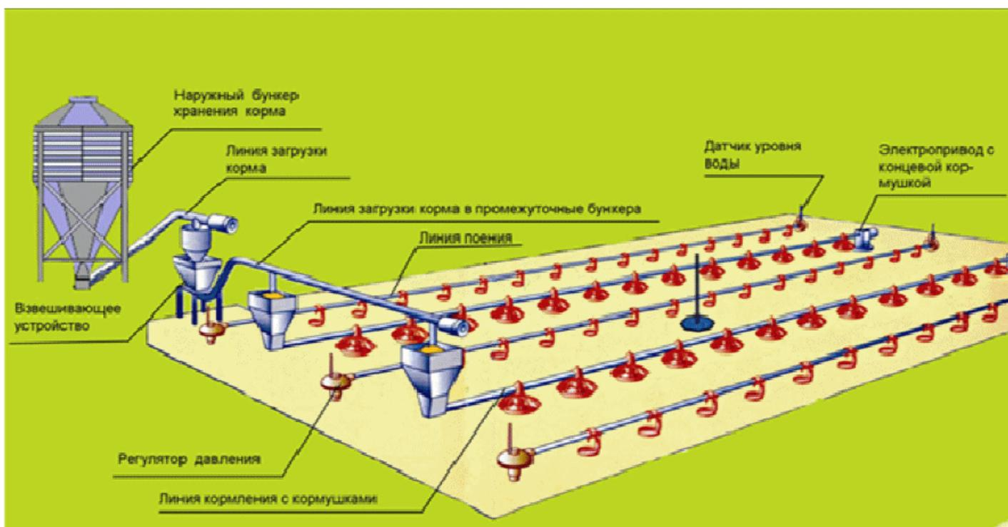
Рисунок 2.8 - Оборудование для напольного выращивания бройлеров
