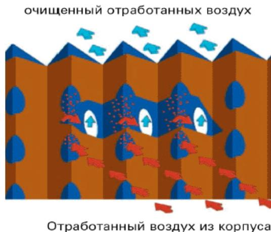
Рис.7.4 - Схема сухого фильтра
