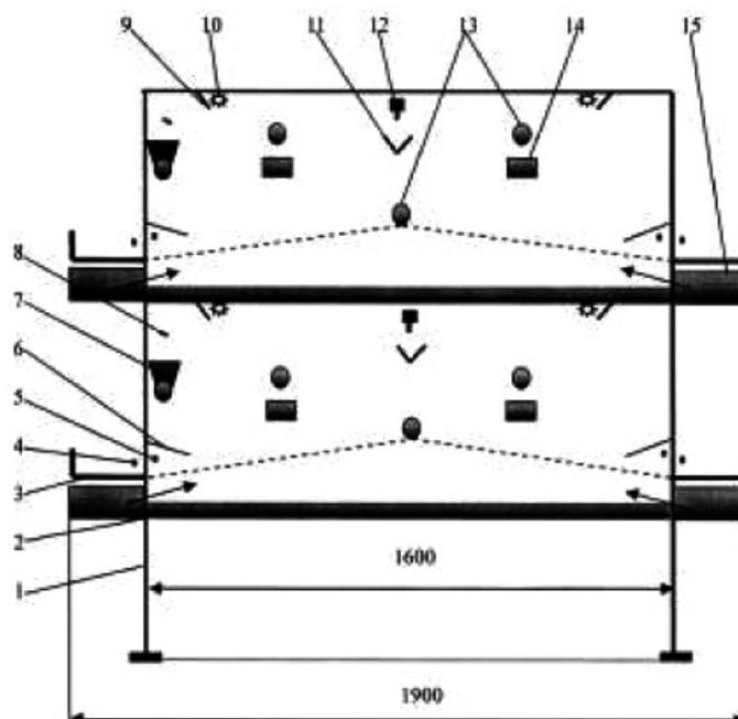
Рисунок 2.11 - Клеточная батарея для содержания родительского стада бройлеров, разработанная в РФ: 1 - каркас, 2 - транспортер для удаления помета, 3 - транспортер для сбора яиц, 4 - канат, 5 - электропастух, 6 - козырек, 7 - кормораздатчик для пастухов\*, закольцованный на 2 яруса, 8 - струна, 9 - кран, 10 - светильник, 11 - каплеуловитель, 12 - поилка, 13 - насест, 14 - кормораздатчик для кур, 15 - воздуховод
