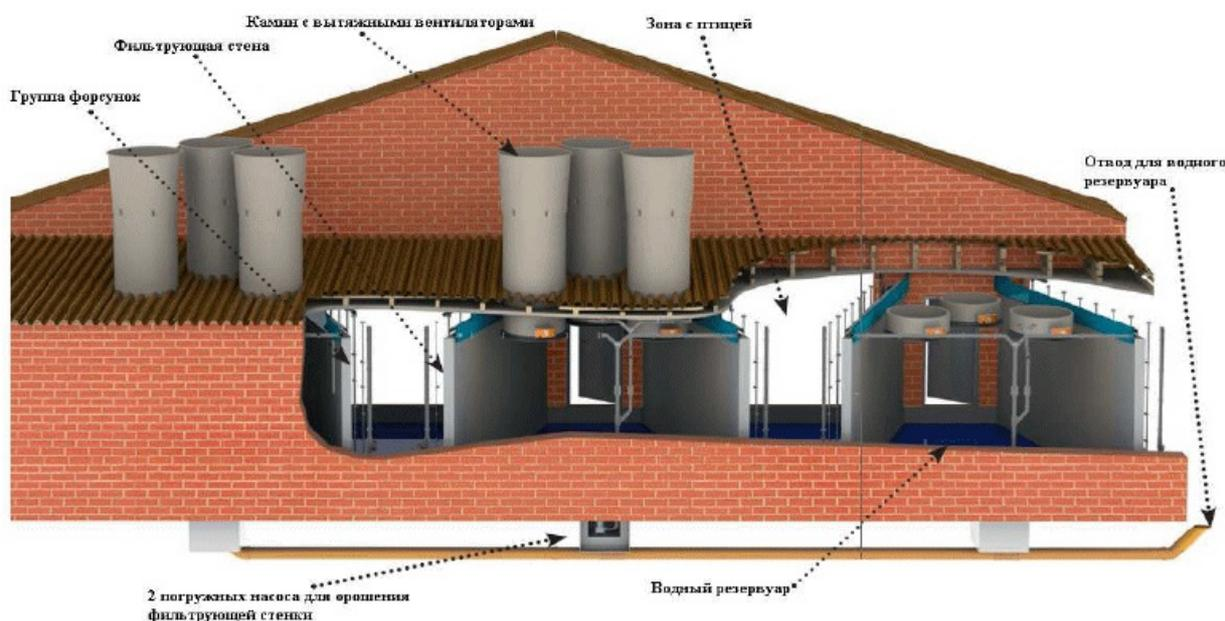
Рис.7.2 - Схематическое изображение очистителя воздуха
