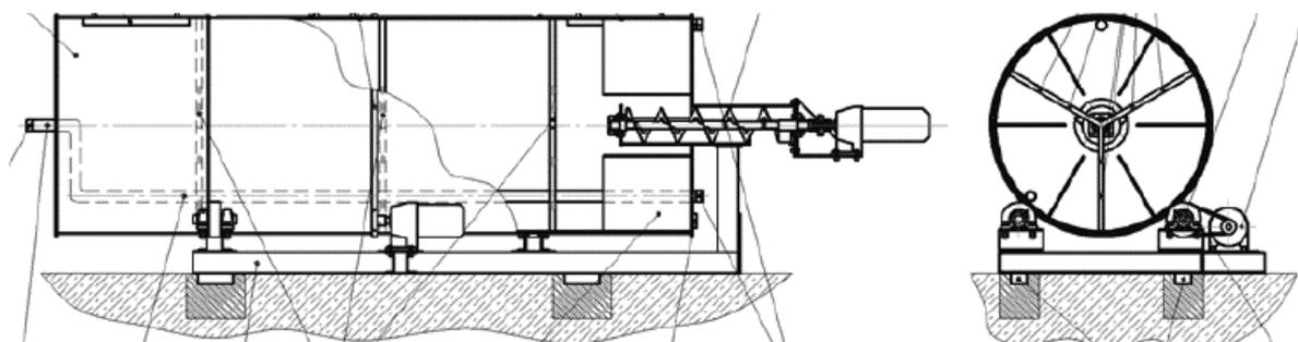
Рисунок 2.13 - Общая схема биоферментатора барабанного типа
