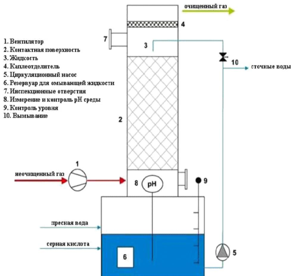
Рис.7.1 - Рабочий процесс биоскруббера
