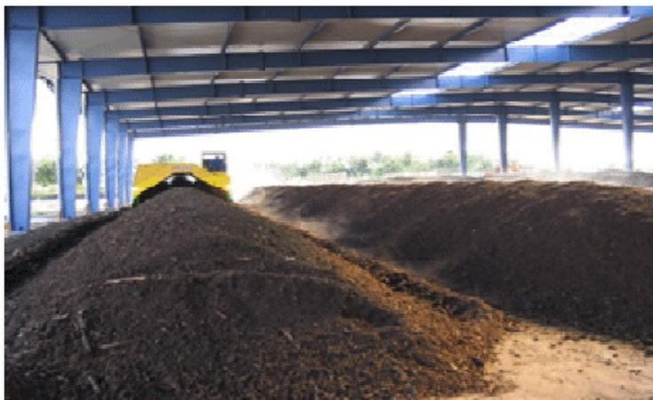
Рис.5.1 - Перемешивание и аэрация буртов
