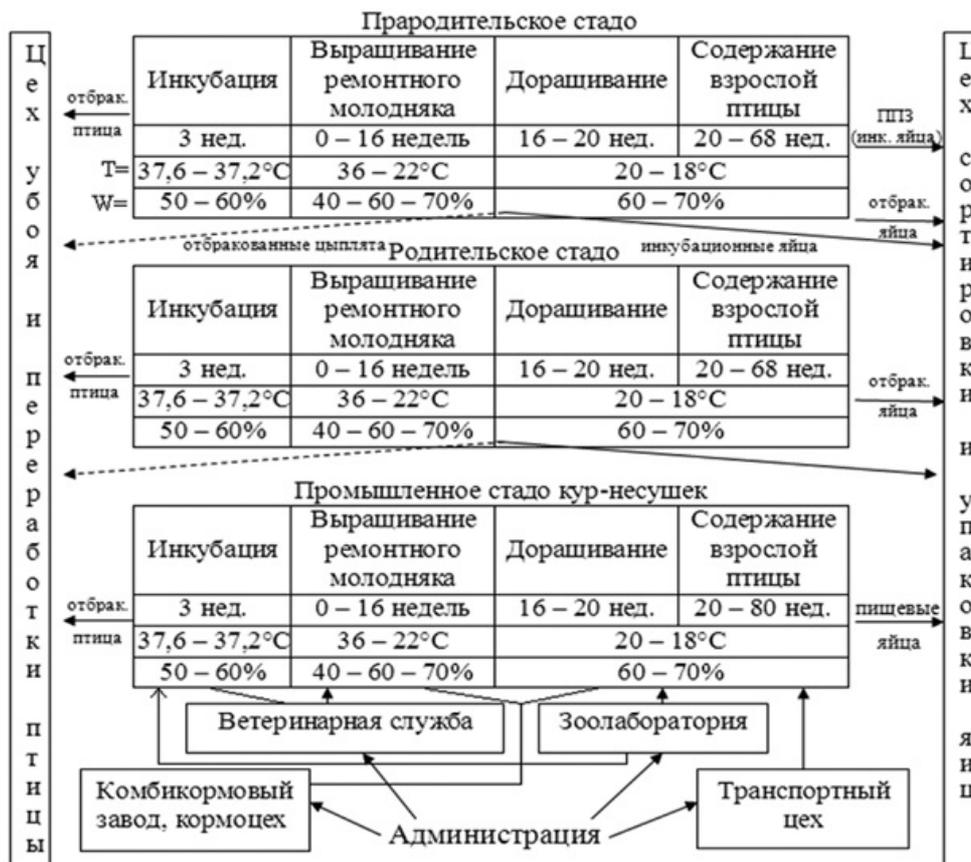
Рис.2.1 - Схема технологического процесса производства яиц
