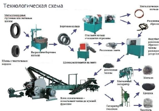
Рисунок 2.11 - Технологическая схема по утилизации изделий из резины, потерявших потребительские свойства (шин, покрышек, камер резиновых) в резиновую крошку ([111])
