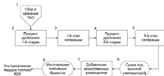
Рисунок 2.22 - Схема технологии производства альтернативного твердого топлива RDF
