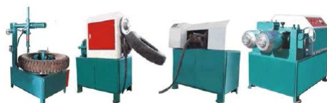
Рисунок 2.10 - Станки для подготовки РТО к утилизации: вырезатель посадочного кольца, разрезатель на ленту, разрезатель на куски, выжиматель посадочного кольца
