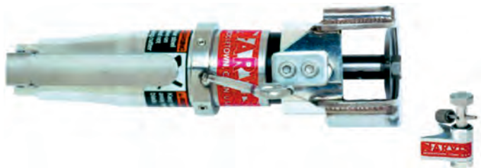
Рис. 37. Резак модели Jarvis OGC для удаления сальных желез у кур, уток и индеек
