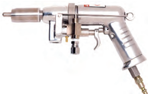
Рис. 36. Устройство модель Jarvis VC для вырезания клоаки у птицы
