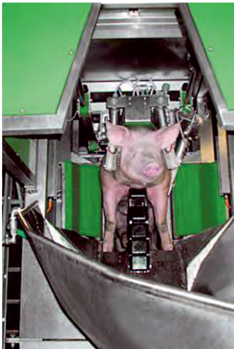
Рис. 8. Бокс BRT для оглушения свиней постоянным током высокой частоты
