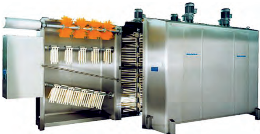
Рис. 16. Машины предварительной зачистки, мойки и сушки туш
